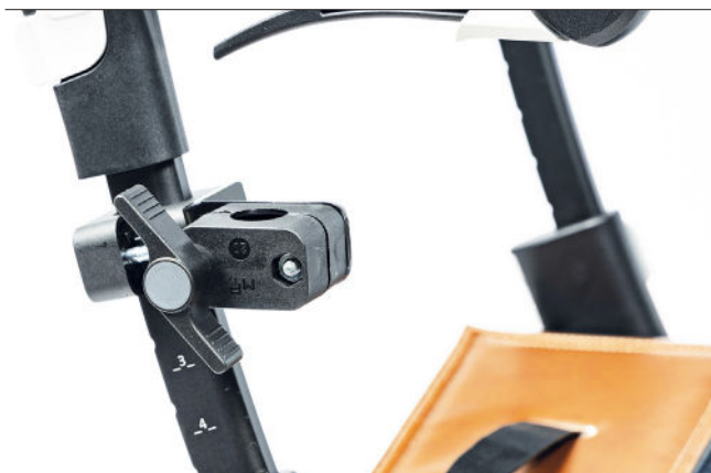
Abbildung 9: Die Montage am Rahmenrohr Ihres Rollz Flex sollte so weit oben wie möglich erfolgen.
