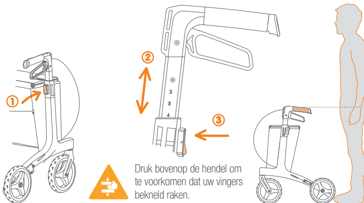
Figuur 5: Handgreephoogte afstellen op gebruiker.
