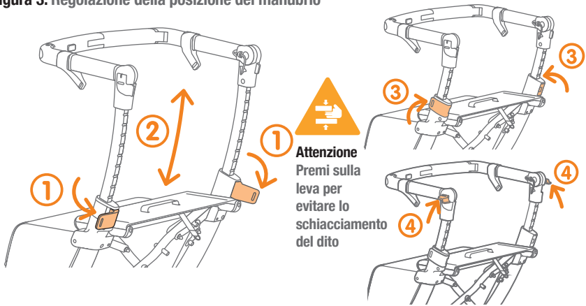
Figura 3: Regolazione della posizione del manubrio
