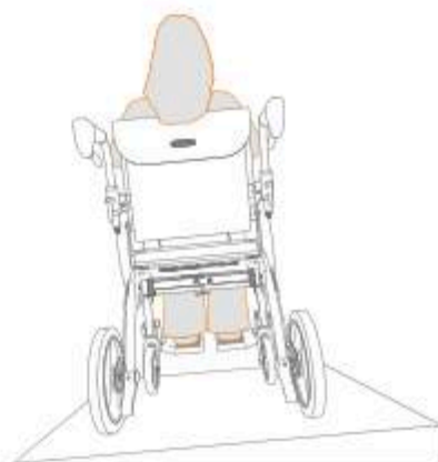
Figure 52: L'inclinaison latérale maximale doit être de 3.5^\circ .
