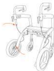
Figure 56: Réglage des freins à l'aide des boulons de réglage situés en haut et en bas du câble de frein.
