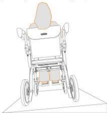
Figuur 52: De maximale zijwaartse hellingshoek is 3,5^\circ .
