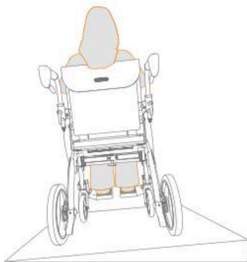
Abbildung 52: Die maximale Seitenneigung beträgt 3.5^\circ .
