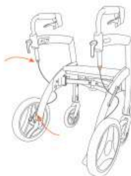
Figure 56: Bremsjustierung mit den Justierschrauben oben und unten am Bremsseil.
