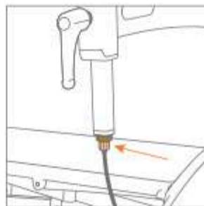
Figure 57: Détail du réglage du frein via le boulon de réglage en haut, juste en dessous du boulon de protection.
