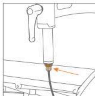
Abbildung 57: Detail der Bremsjustierung über die Justierschraube, direkt unter dem Verriegelungsring.
