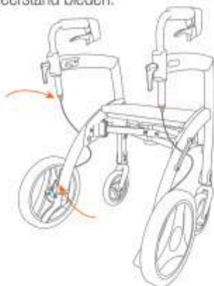
Figuur 56: Remafstelling via de stelschroeven boven en onderaan de remkabel.
